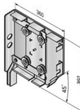
Стальная, в сборе с кареткой. Для роллетных систем с большой массой роллетного полотна. Применяется совместно с направляющими шинами **GR75×27/S, GR90×35, GR75×27E, GR70×34E, GR90×34E, GR100×35, GR90×33(I)**
