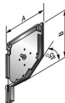
Для защитных коробов серии SB45. Алюминиевая. Применяется совместно с направляющими шинами **GR53×22/eco, GR45×22/eco, GR60×21/S, GR65×24E, GRM65×26, GR45×22E, GR45×60E, GR53×22E, GR53×34E, GR53×42E, GR53×60E, GRM66×27E**
