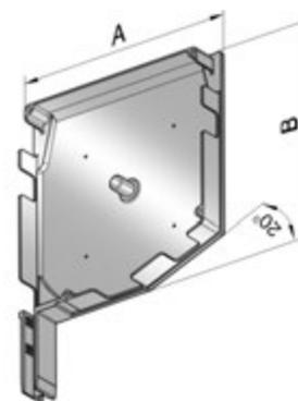
Для защитных коробов серии **SB20**. Алюминиевая. Применяется совместно с направляющими шинами **GR53×22/eco, GR45×22/eco, GR60×21/S, GR65×24E, GRM65×26, GR45×22E, GR45×60E, GR53×22E, GR53×34E, GR53×42E, GR53×60E, GRM66×27E**
