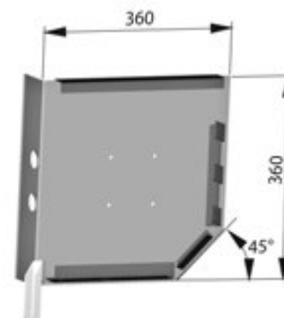
Стальная, без каретки. Для роллетных систем с большой массой полотна. Применяется совместно с направляющими шинами **GR75×27/S, GR90×35, GR75×27E, GR70×34E, GR90×34E, GR100×35, GR90×33(I)**
